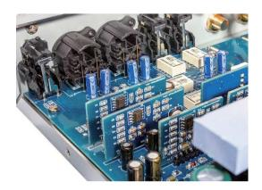
Der Phonoeingang verfügt über eine Vielzahl von Einstellungen für Eingangswiderstände und Kondensatoren, die zu verschiedenen MM-Tonabnehmern passen. Der PRA-9X Phonoverstärker ist ein 2-stufiger RIAA-Verstärker, der den NJR MUSES8820 Audioqualitäts-Operationsverstärker verwendet, um eine genaue RIAA-Kurve und geringe Verzerrung bei hohen Verstärkung und Leistung.
